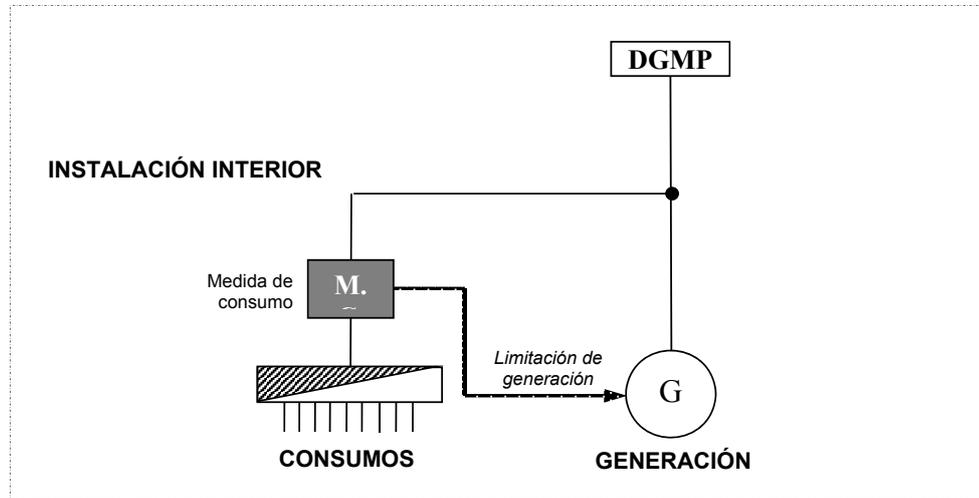
Figura 4: Esquema de medida del consumo de energía en instalaciones conectadas a redes de alta tensión
