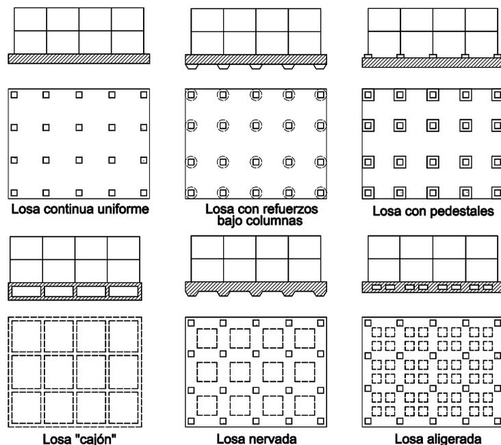
**Figura 4.6. Tipos de losas de cimentación**
