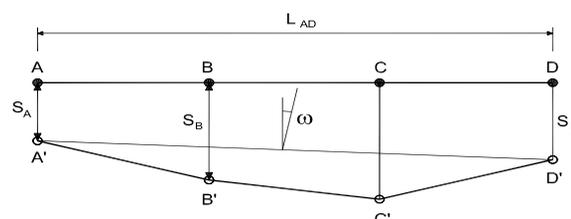
Figura 2.1. Definiciones básicas del movimiento de cimentaciones
