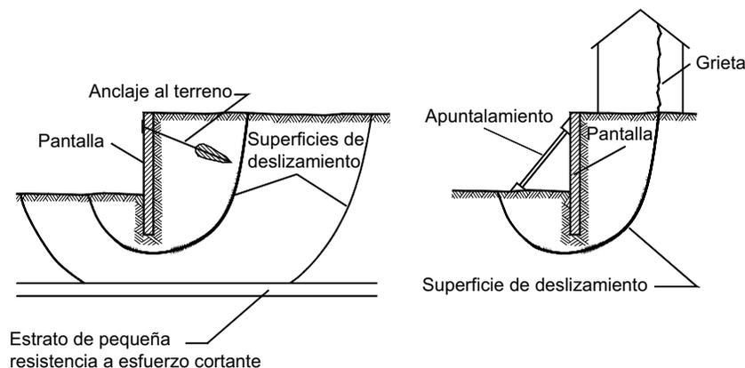
Figura 6.9. Formas de rotura por deslizamiento profundo
