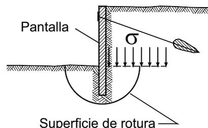
Figura 6.11. Estabilidad del fondo de la excavación
