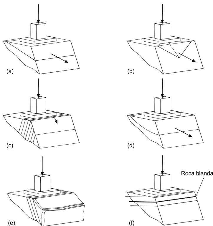
**Figura 4.10. Efectos de la estructura geológica en la comprobación de la estabilidad y deformabilidad de cimentaciones en roca.** (a) Deslizamiento a favor de planos de discontinuidad (bloque). (b) Deslizamiento en presencia de varias familias de discontinuidades (cuña) (c) Vuelco de estratos (toppling) (d) Rotura generalizada en macizos muy fracturados. (e) Pandeo de estratos (f) Comprobación de asientos en alternancias de rocas de diferente deformabilidad
