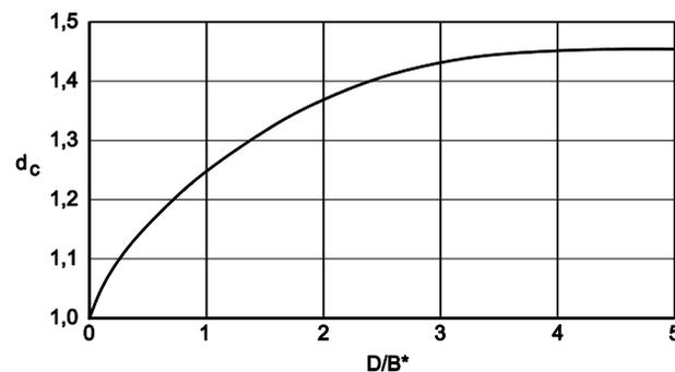
**Figura F.2. Coeficiente de corrección (dc)  $\approx d_c = 1 + 0,34 \cdot \arctg(D/B^*)$**
