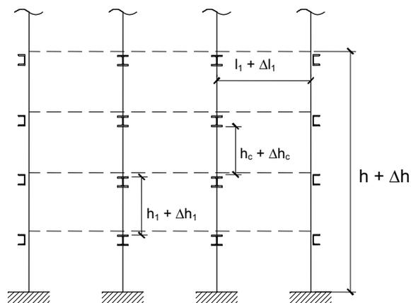
$h_1$  nivel de la cara superior de una losa de piso apoyada en el pilar
