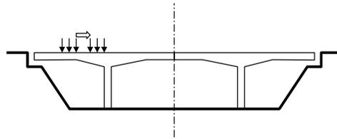
Definición de los detalles a comprobar y obtención del registro de tensiones en cada uno
