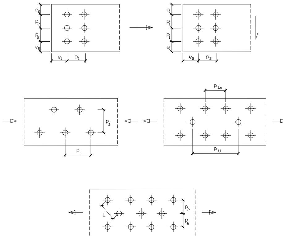
Figura 8.2 Disposiciones constructivas
