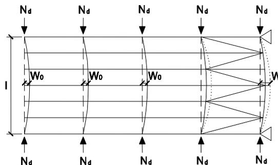
Figura 5.4 Flecha inicial de los elementos a estabilizar
