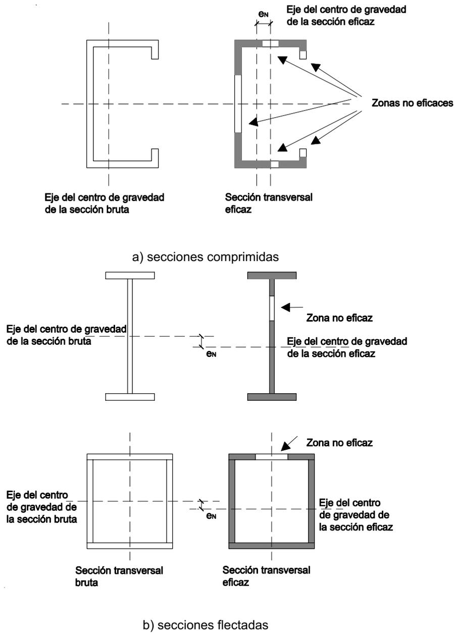
Figura 5.2 Secciones eficaces
