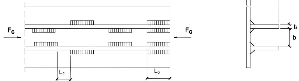
b) Compresión  $L_1 \leq 12 t, 12 t_1, 0,25b, 200\text{mm}.$   $L_0 \geq 0,75 b_1, 0,75 b$
