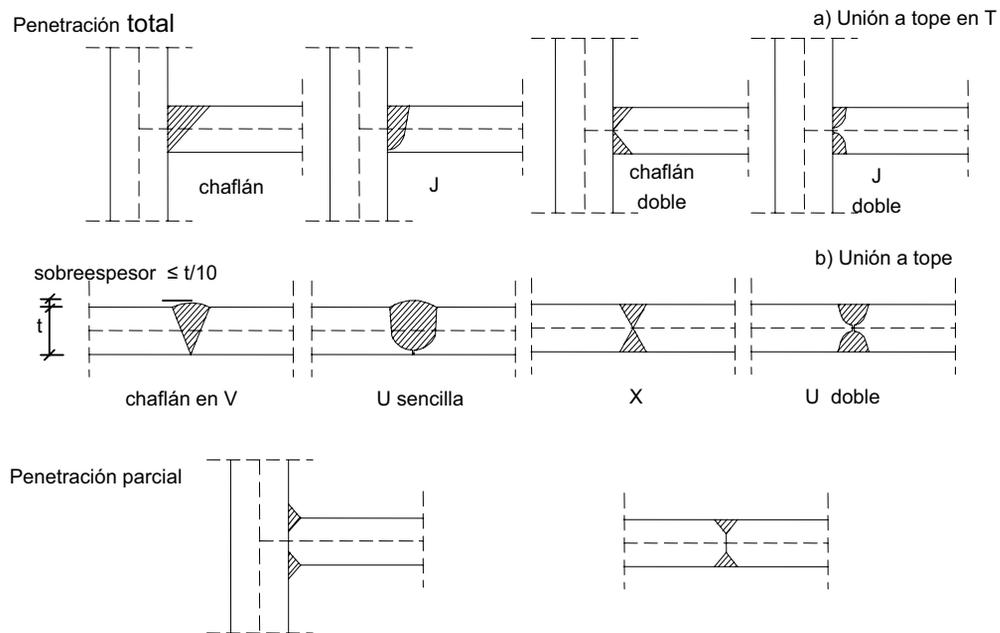
Figura 8.8 Soldadura a tope y formas de preparación
