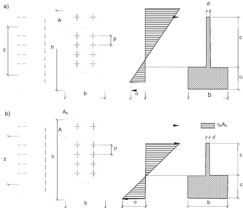
**Figura 8.17 Empalmes con chapa frontal; sección equivalente**
