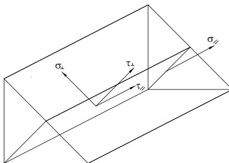
Figura 8.10 Tensiones en la sección de garganta
