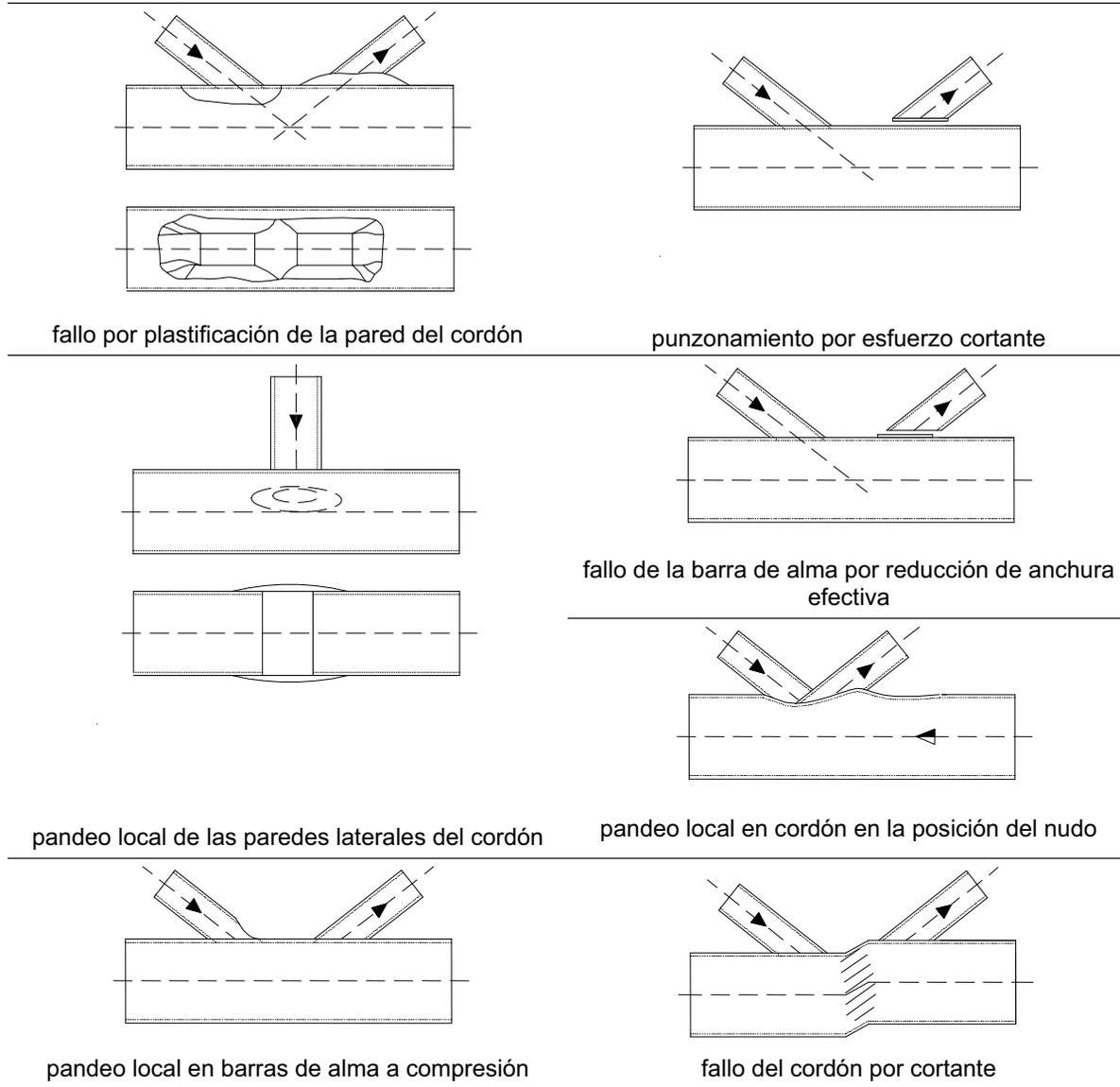
Figura 8.25 Modos de fallo. Secciones rectangulares
