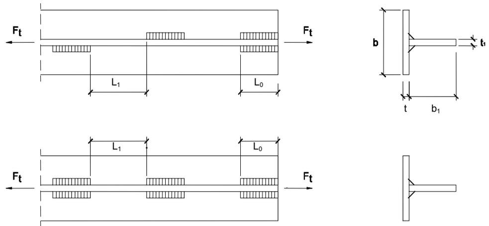
a) Tracción  $L_1 \leq 16 t, 16 t_1, 200\text{mm}.$   $L_0 \geq 0,75 b_1, 0,75 b$
