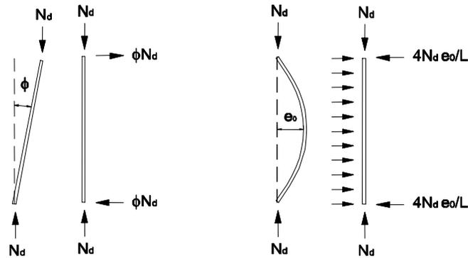
Figura 5.5 Acciones equivalentes a las imperfecciones iniciales
