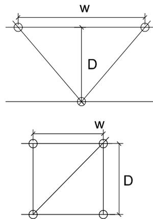
Desviaciones para componentes de celosía fabricados de sección transversal total después del soldeo:
