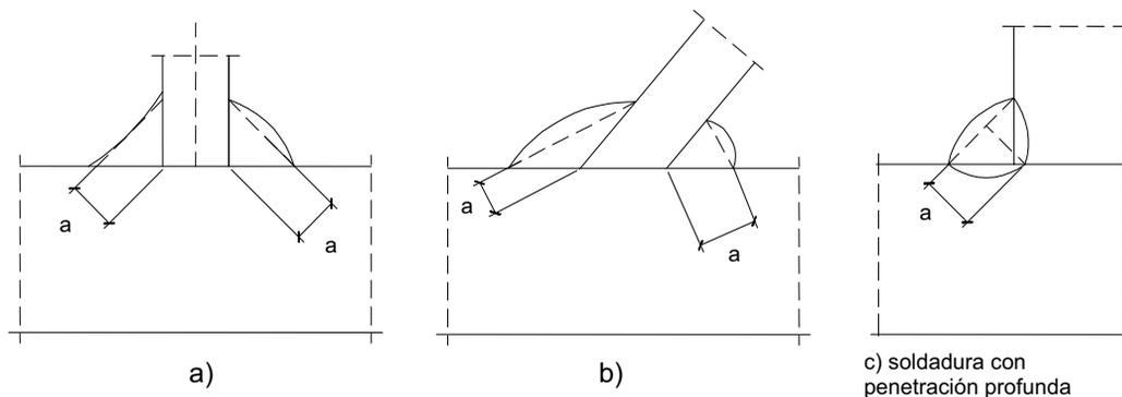
Figura 8.9 Soldadura en ángulo. Espesor de garganta
