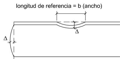
Distorsión  $\Delta$  en la anchura de la chapa o longitud de referencia:
