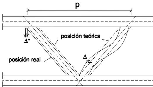
Desviaciones para la excentricidad de nudo en componentes de celosía fabricados:
