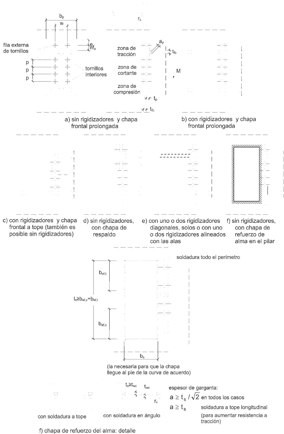
Figura 8.19. Uniones viga-pilar con chapa frontal atornillada
