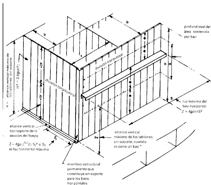
**NOTA.-** Si no se instalan palmejares, el espesor de los tableros verticales de madera vendrá dado por la fórmula  $t^2 = 3,6 \cdot \rho \cdot b \cdot h^2$ . Al instalarse palmejares, la luz máxima toma el valor  $h_r$ , por lo que el espesor de la madera vendrá dado por:
