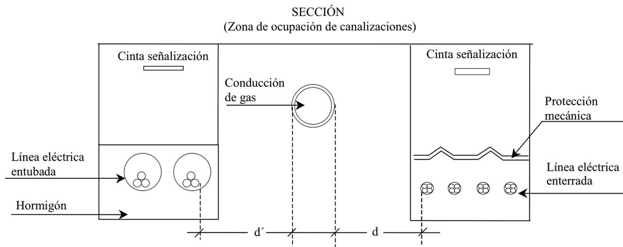
La distancia mínima entre los empalmes de los cables de energía eléctrica y las juntas de las canalizaciones de gas será de 1 metro.
