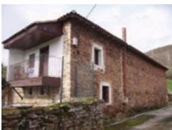
*Modificación integral del hastial y la cubierta, apertura de huecos laterales, chimenea en fachada*
